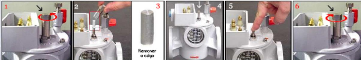
Outra forma de verificação dos contatos é a aplicação de gás ou ar no relé através da utilização de uma bomba manual ou outro dispositivo similar, injetando gás ou ar lentamente pelo registro superior do relé até o acionamento do contato do alarme (1º, Nível). O contato de desligamento, geralmente não pode ser verificado desta forma, pois o gás/ar dispersa para o tanque de expansão antes de atingir o nível de desligamento.
