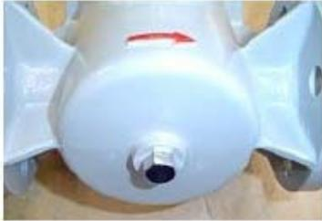
Na parte inferior está localizado o bujão de dreno (1/8" BSP) para eventual escoamento do óleo ou para verificação de funcionamento do relé ou para a coleta de amostras de óleo.
